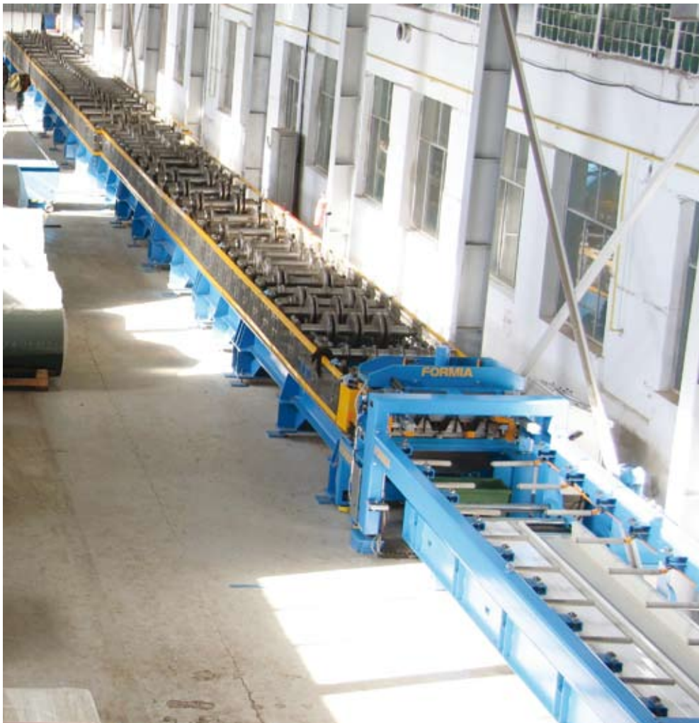
Линия по производству несущего профнастила ТП 128 изготовлена фирмой «Формиа» (Formia, Финляндия) по заказу ТПК. При изготовлении материала используется только высококачественная сталь, поставщиками которой являются корпорации «АрселорМиттал» (ArcelorMittal, Германия), «ФёстАльпинэ» (VoestAlpine, Австрия) и «Северсталь» (Россия).
